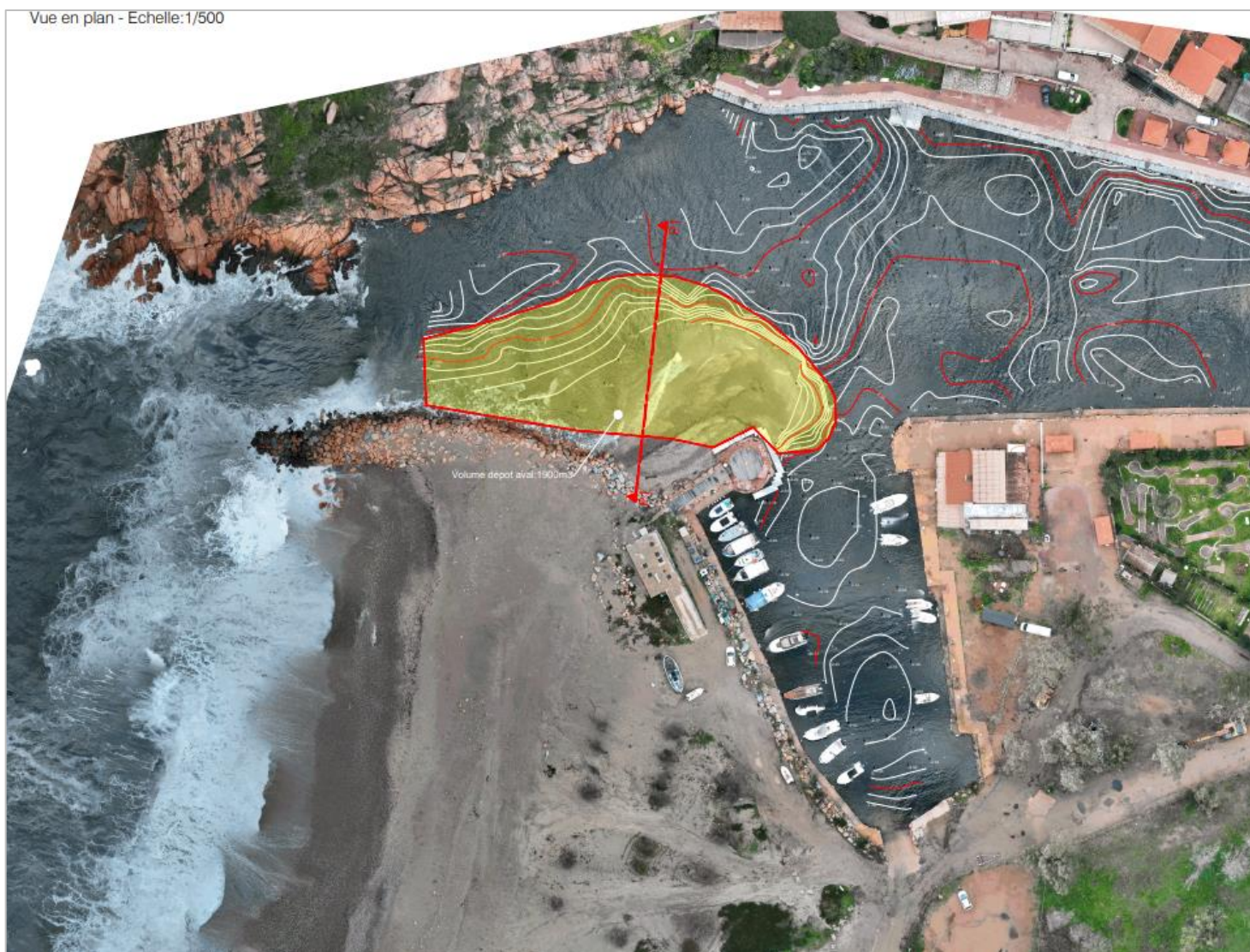
Vue en plan du dragage à effectuer (2 000 m 3 ) : Zone aval passerelle au niveau de la station avitaillement
