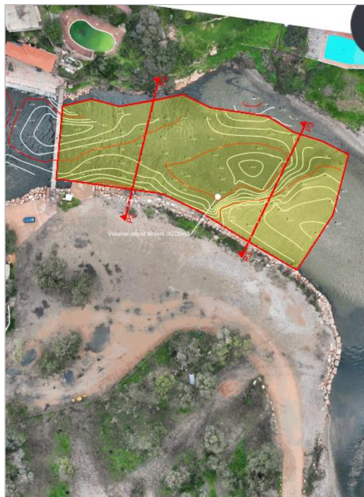
Vue en plan du dragage à effectuer (1 000 m 3 ) : Zone amont passerelle
