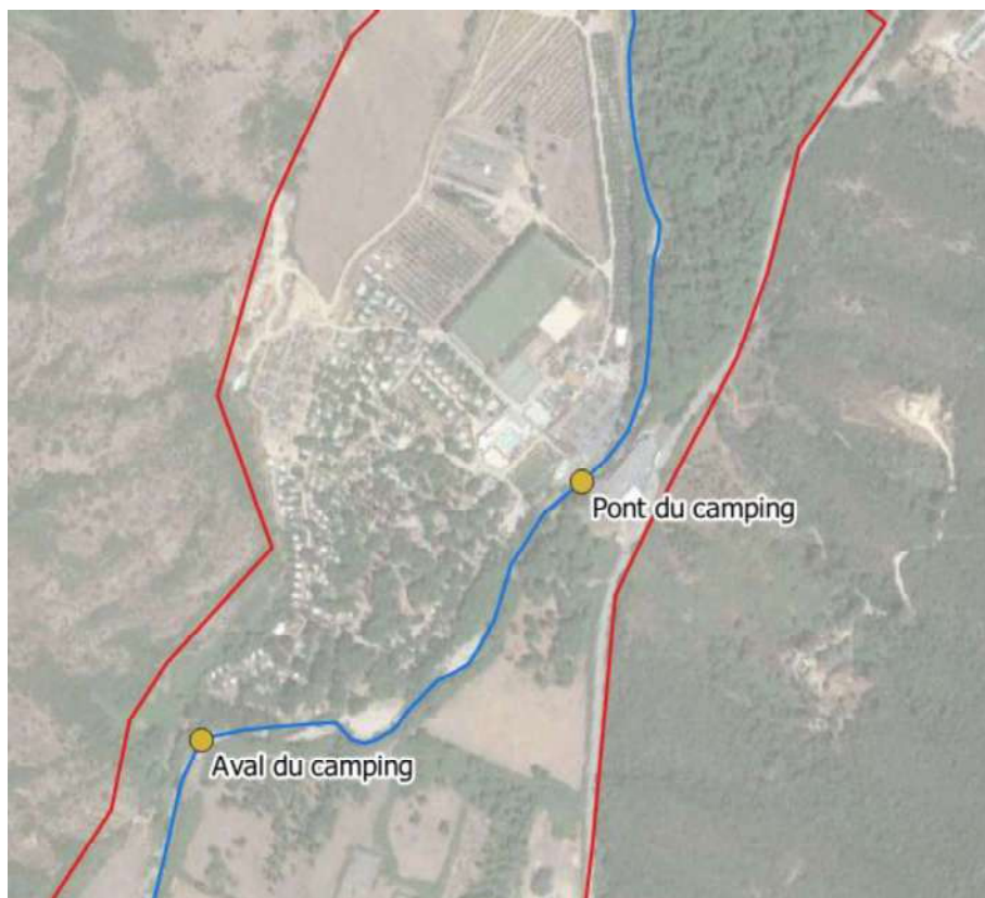
Fig. 7. Points de calage du modèle hydraulique (crue de 1992)
