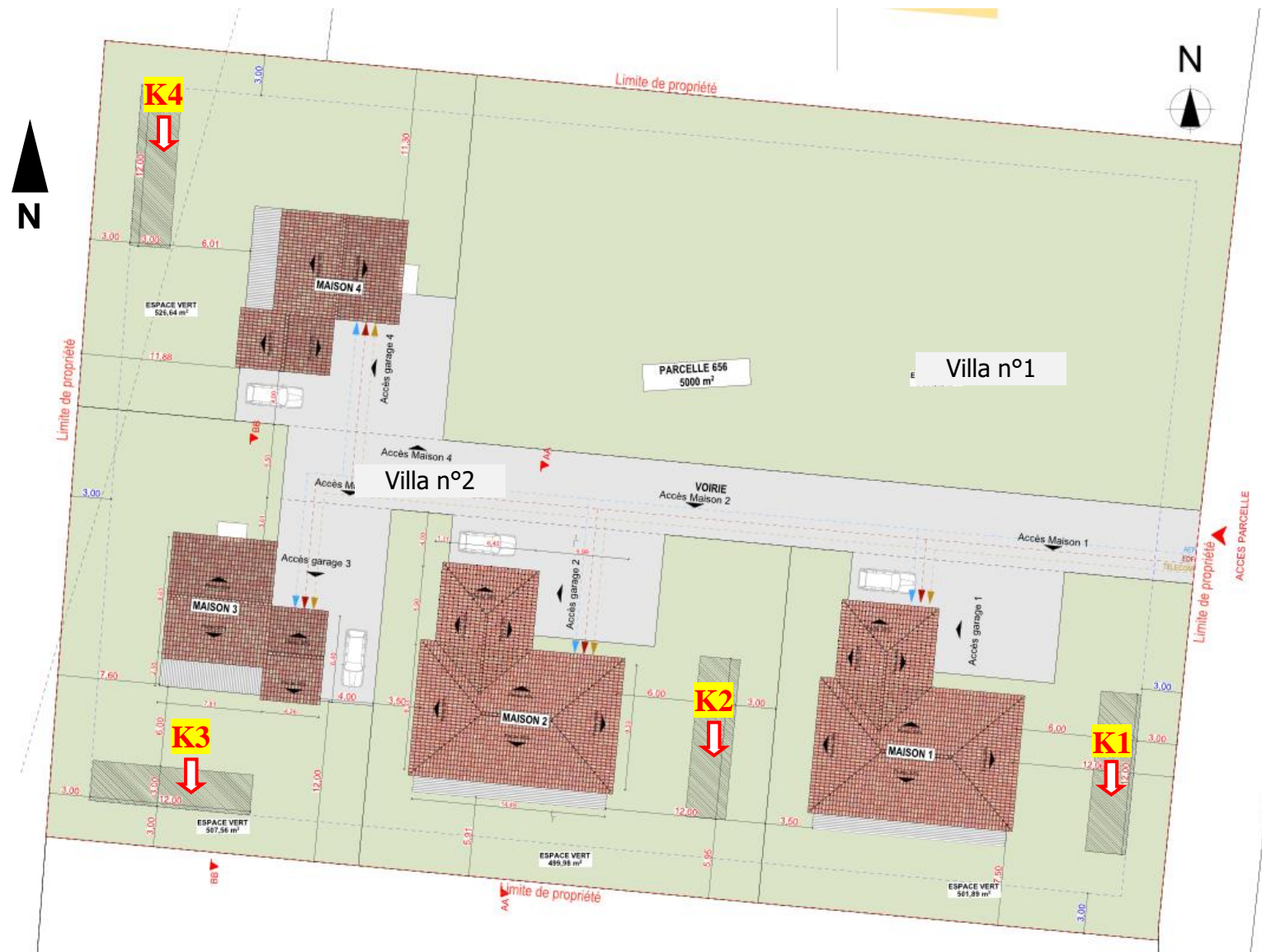
Fig. 4 – Mesures de perméabilité et extrait du plan de masse du projet de construction des 4 maisons individuelles de type T4 (F. D. ARCHITECTURE)
