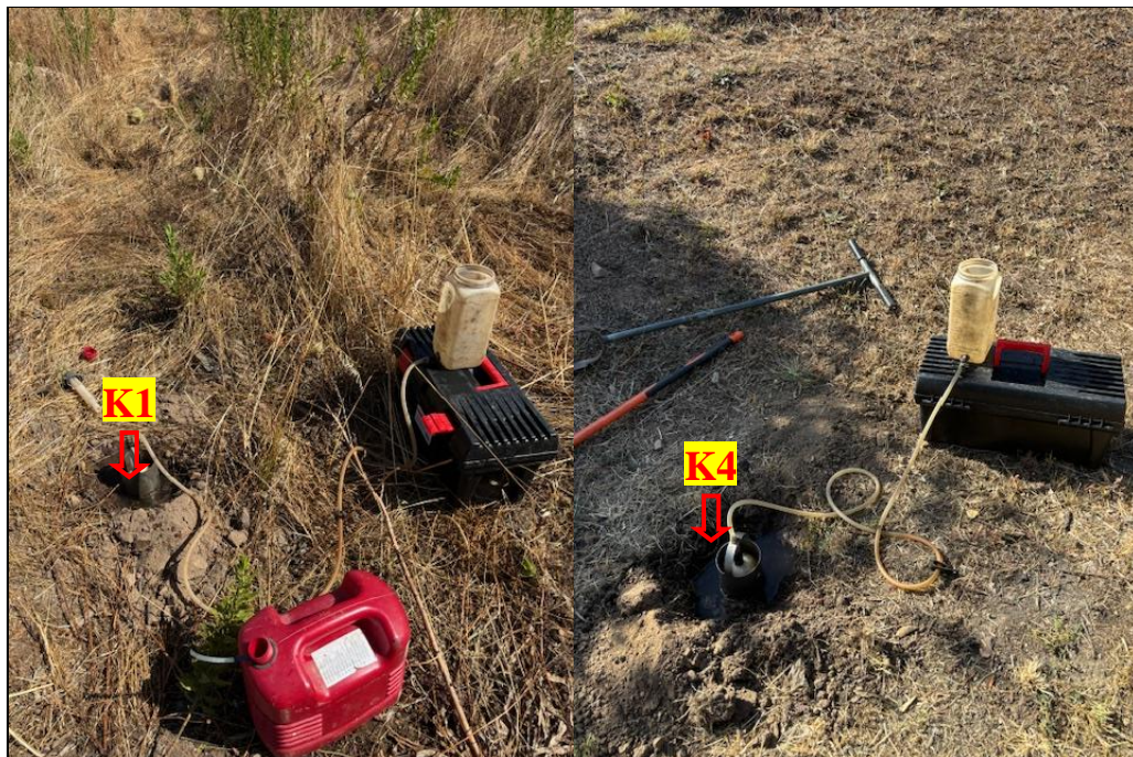
Fig. 8 – Mesures de perméabilité K1 et K4 à proximité des abords de la parcelle, sur un sol peu tassé et assez naturel, à proximité des zones dédiées aux épandages
