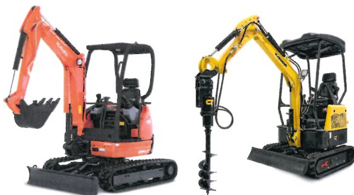
Figure 5: Illustrations d'une mini-pelle à godet (gauche) et d'une mini-pelle à foreuse (droite), pour la pose des poteaux téléphoniques
