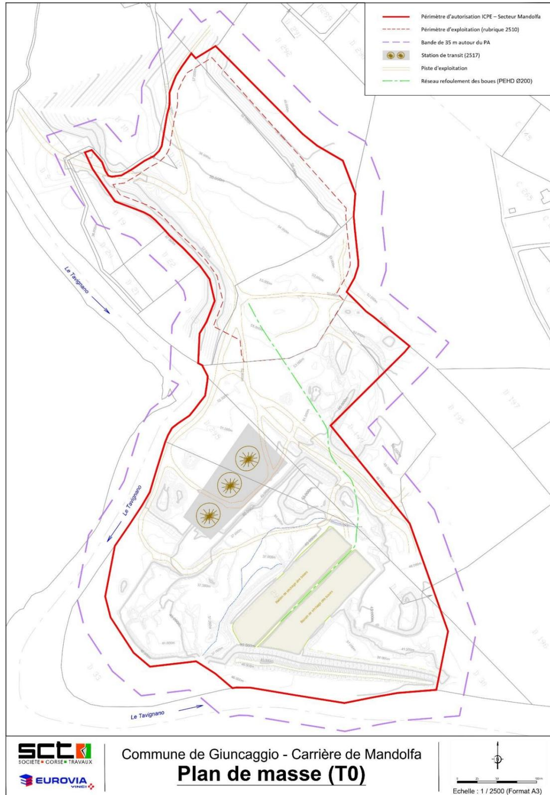
Figure 4 : Aménagement de l'extension de carrière plan de masse (T0) (Source : Arca2e)
