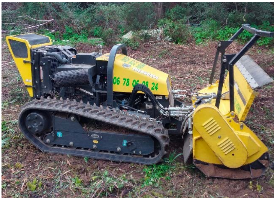
Un exemple d'engin léger : un chenillard télécommandé avec chenille en caoutchouc (GEN Corse)
