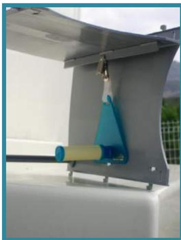
Figure 9 : Échantillonneur passif pour les BTEX installé dans une boîte de protection contre les intempéries (Source : Qualitair Corse)
