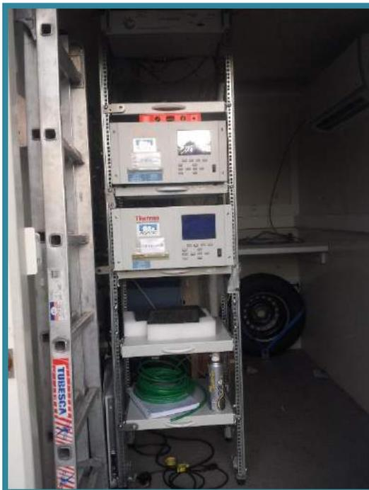
Figure 4 : Intérieur d'une station mobile de surveillance de la qualité de l'air de type remorque (Source : Qualitair Corse)
