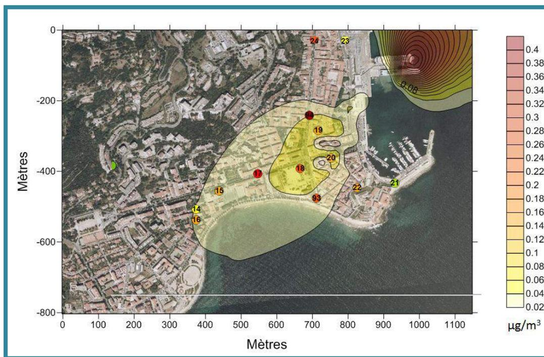
Carte 31 comparaison entre les résultats du modèle et la cartographie par échantillonneurs passifs (NO<sub>2</sub> - zone 2) (Source : Qualitair Corse)
