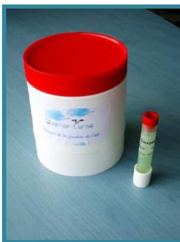
Figure 7 : Échantillonneur passif pour le dioxyde d'azote (NO<sub>2</sub>) et sa boîte de protection contre les intempéries (Source : Qualitair Corse)
