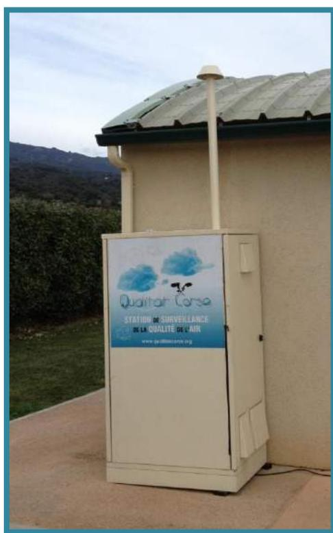
Figure 6 : Station mobile de surveillance de la qualité de l'air de type armoire (Source : Qualitair Corse)
