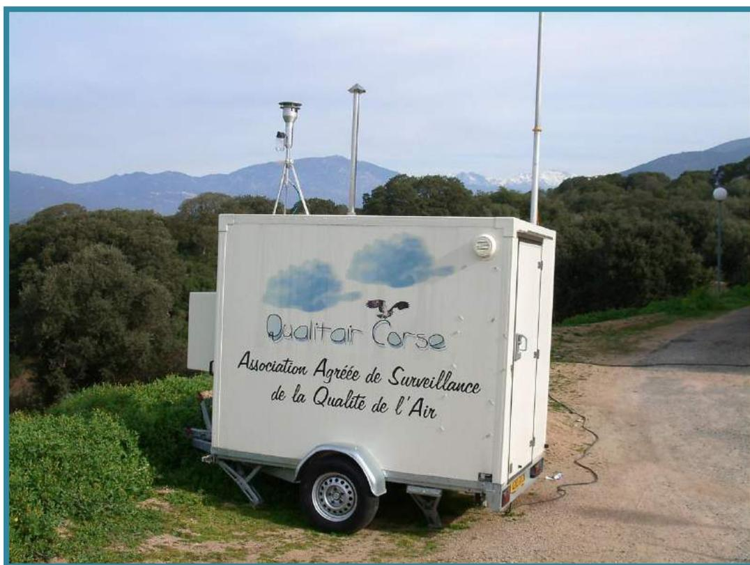
Figure 3 : Station mobile de surveillance de la qualité de l'air de type remorque (Source : Qualitair Corse)
