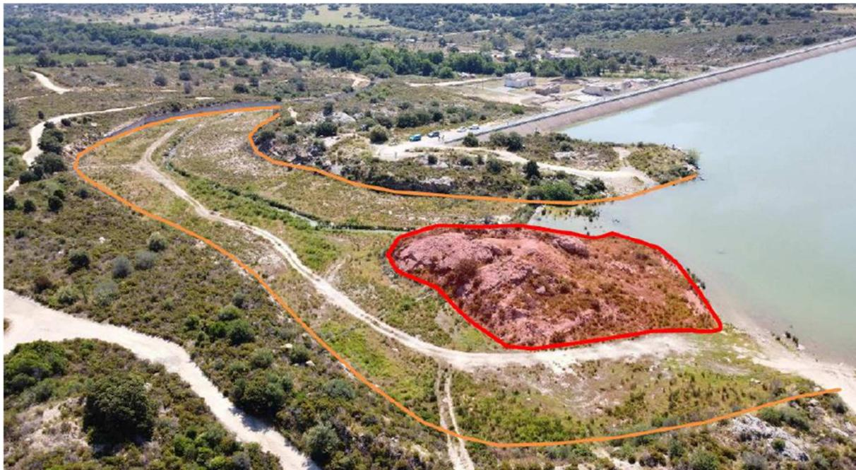
Figure 4. Evacuateur de crues actuel (orange) et merlon rocheux à abattre (rouge) (source : OEHC)
