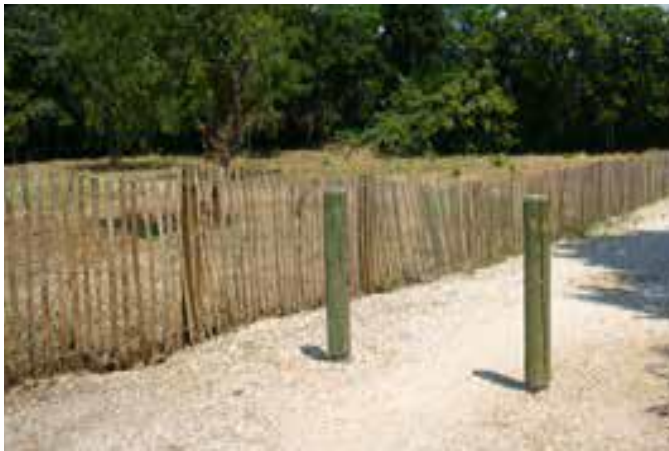
Dispositif entre plage et parking : Chaque module de stationnement est prolongé par un chemin d'accès à la plage, bordé de ganivelles.
