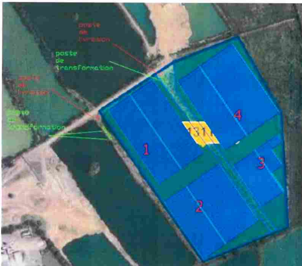
Figure 1 : Extrait du plan de masse du projet de centrale solaire flottante de Lucciana, figuré
