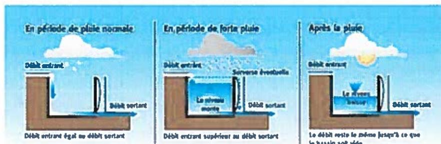
Figure 9 : Principe de fonctionnement d'un bassin de rétention
