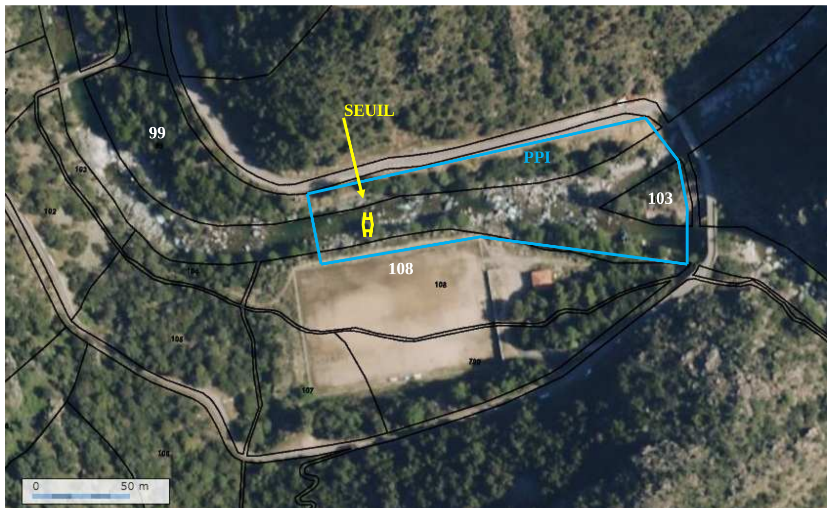
Fig. 5 – Périmètre de Protection Immédiate (PPI) de la prise sur la rivière Porto
