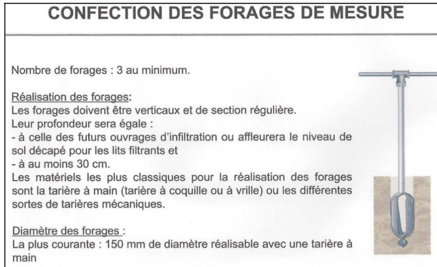
Fig. 6 – Principe du sondage à la tarière manuelle
