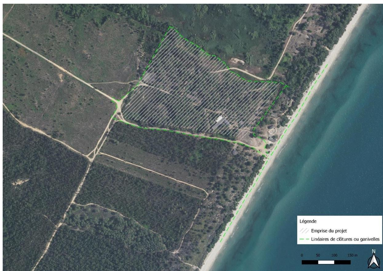
**Figure 36 Schéma de principe de la localisation des linéaires de clôtures ou ganivelles (perméables à la faune) permettant la canalisation du public et la mise en protection des habitats naturels et espèces patrimoniaux environnant le projet**
