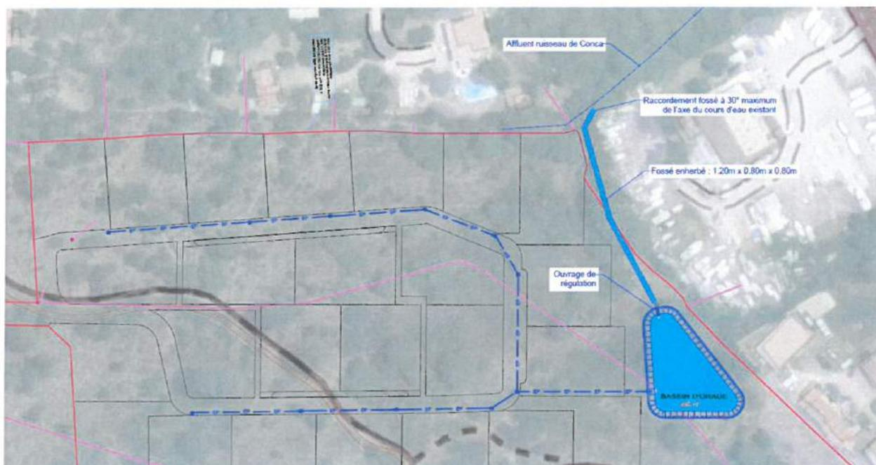
*Extrait du plan de principe de collecte des eaux pluviales*
