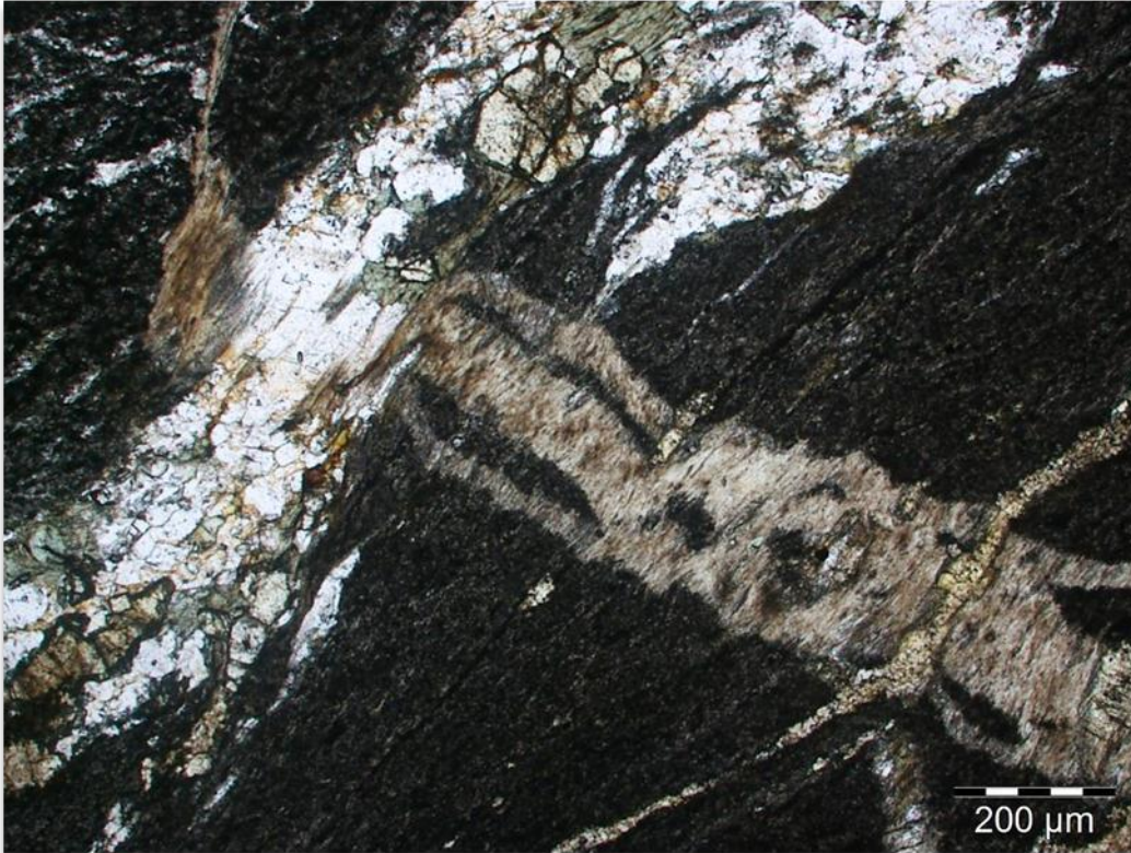
Illustration 49 : Veine d'amphibole fibreuse, recoupant des lits à épidote + amphibole et à albite ± chlorite ± amphibole, recoupée par une veine à épidote, en lumière polarisée non analysée (2BDL246-C).
