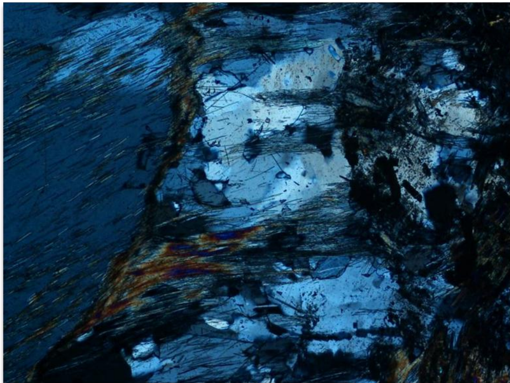
Illustration 69 : Détail d'une veine à albite et amphibole fibreuse, en lumière polarisée analysée (2BDL095(3)).
