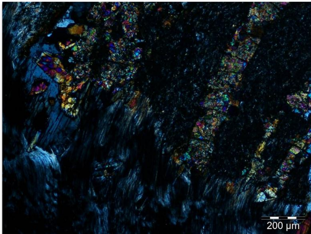
Illustration 48 : Veine à albite ± actinolite-amiante, sécante sur la foliation à lits d'épidote (orangés), épidote + amphibole (sombres), en lumière polarisée analysée (2BDL246-C).
