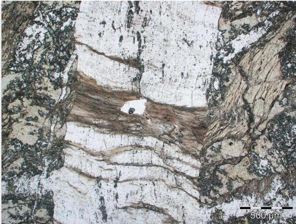
Illustration 63 : Veine à albite + Actinolite-Trémolite-amiante. Les fibres se développent à partir d'amphibole de l'encaissant, en lumière polarisée non analysée (2BDL469-B).
