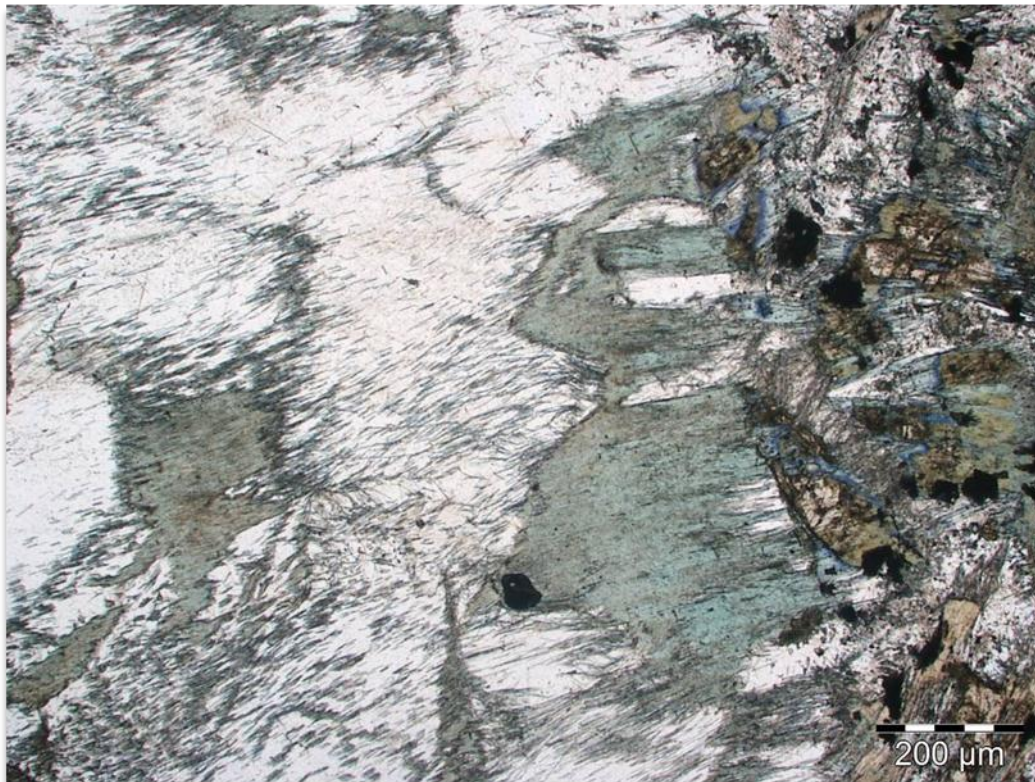
Illustration 66 : Contact entre une veine à albite + amphibole amiantifère verte (à gauche) et un metabasalte (à droite), en lumière polarisée (2BDL095(3)).
