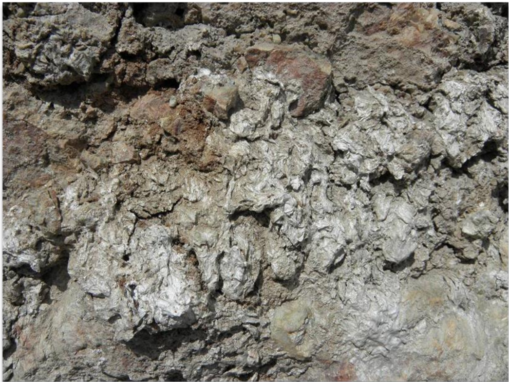
Illustration 33 : Amas microfibreux blanchâtres provenant de la destruction d'un plan de glissement (site 2BFC100).
