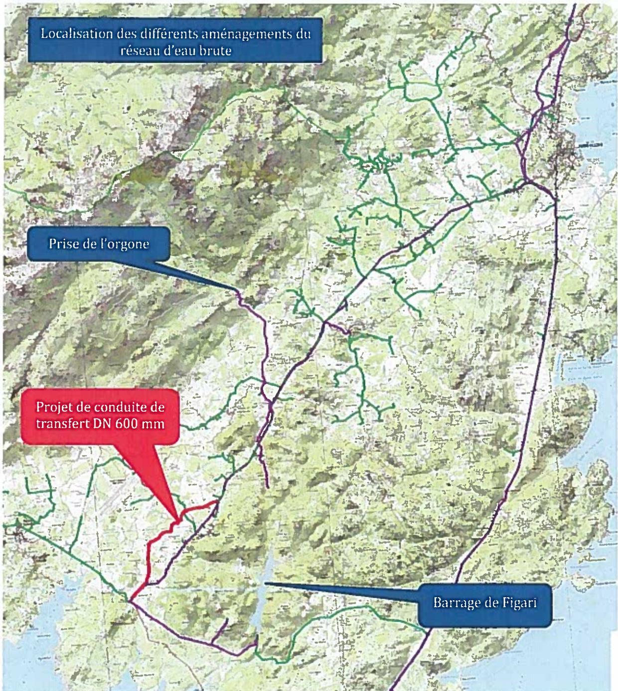
Pose d'une conduite de transfert en DN 600mm
