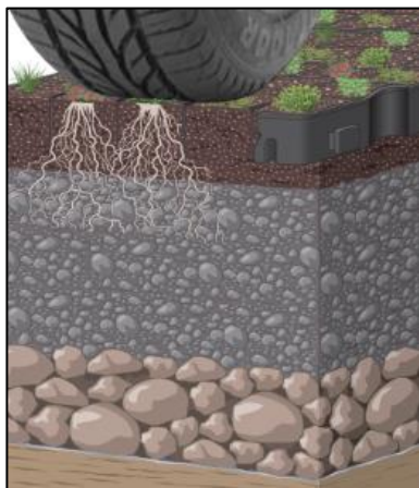
Figure 1 : Support alvéolaire avec substrat perméable végétalisé
