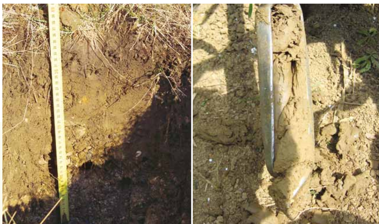
Figure 14 : profils pédologiques - Source : Cerema/DTerCE.
