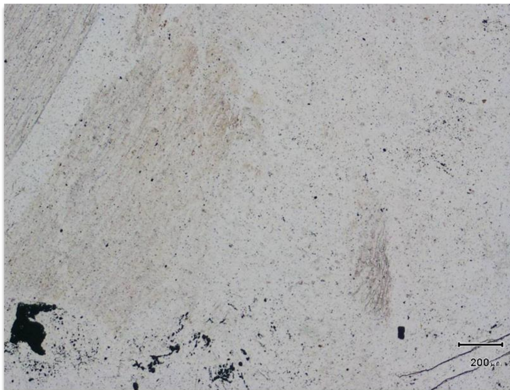
Illustration 44 : Chlorites et serpentines à texture maillée ou fibreuse, en lumière polarisée non analysée (lame 2BDL282).
