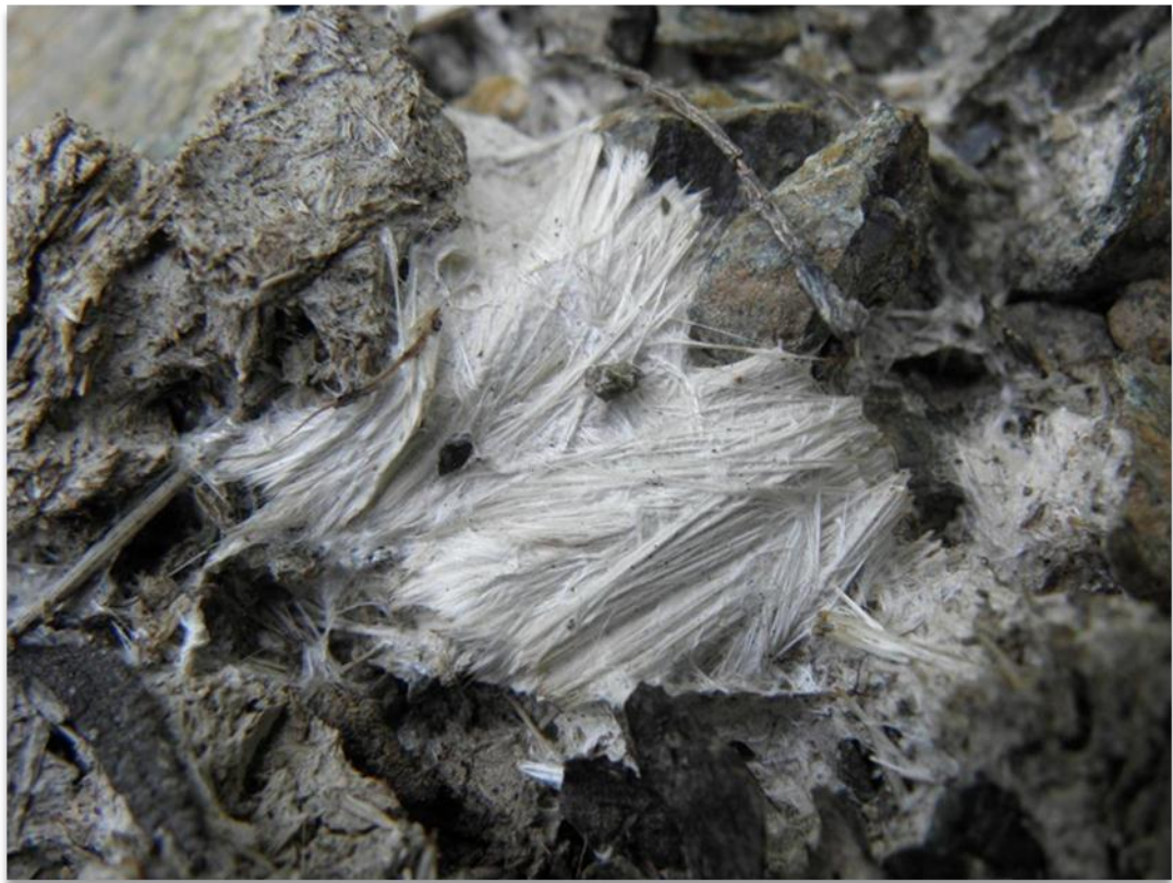
Illustration 102 : Fibres de trémolite échantillonnées au niveau du site 2BDL279.
