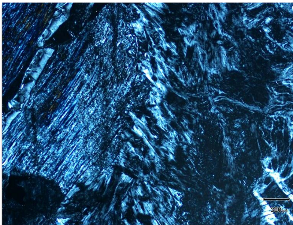
Illustration 45 : Chlorites et serpentines à texture maillée ou fibreuse, en lumière polarisée analysée (lame 2BDL282).
