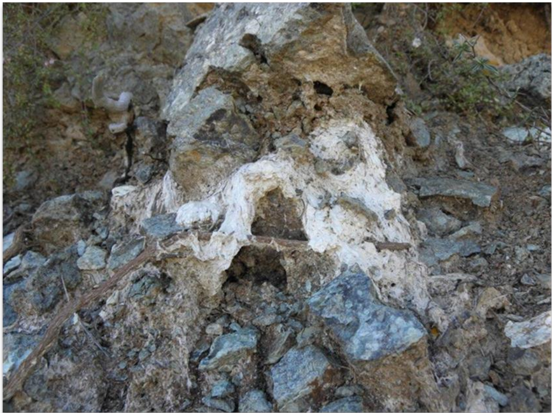
Illustration 8 : Amas d'amiante observé dans le talus de la D39 (site 2BDL273).
