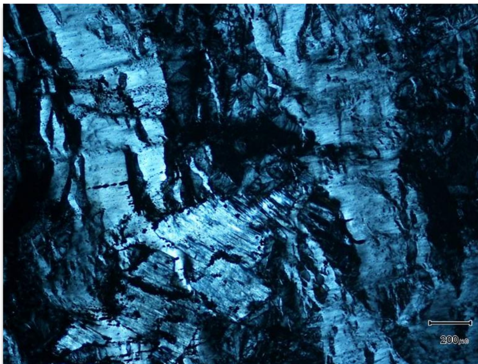
Illustration 47 : Chlorites et serpentines maillées recoupées par des veines de serpentinite tardives, en lumière polarisée analysée (lame 2BDL282).
