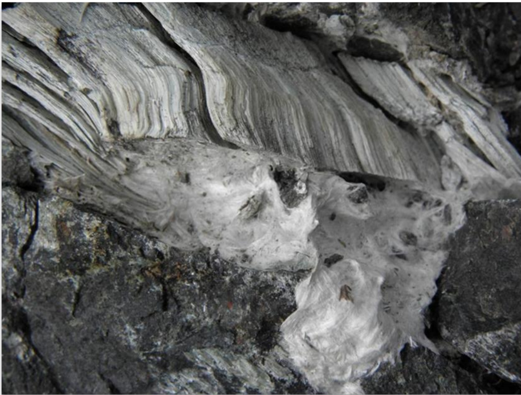
Illustration 10 : Détail de la veine fibreuse rigide (haut) et de l'amas de fibres souples (bas).
