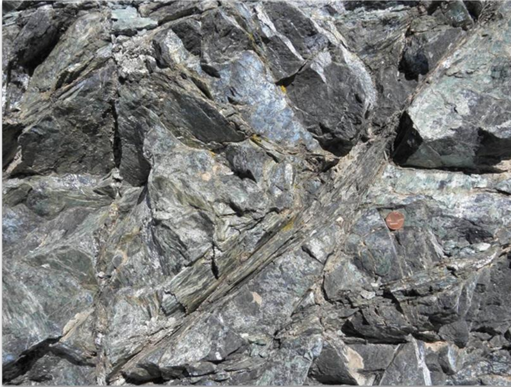
Illustration 21 : Bandes de cisaillement à minéraux fibro-lamellaires verts, observées au sein de serpentinites peu amiantifères et peu altérées (2BFC022).
