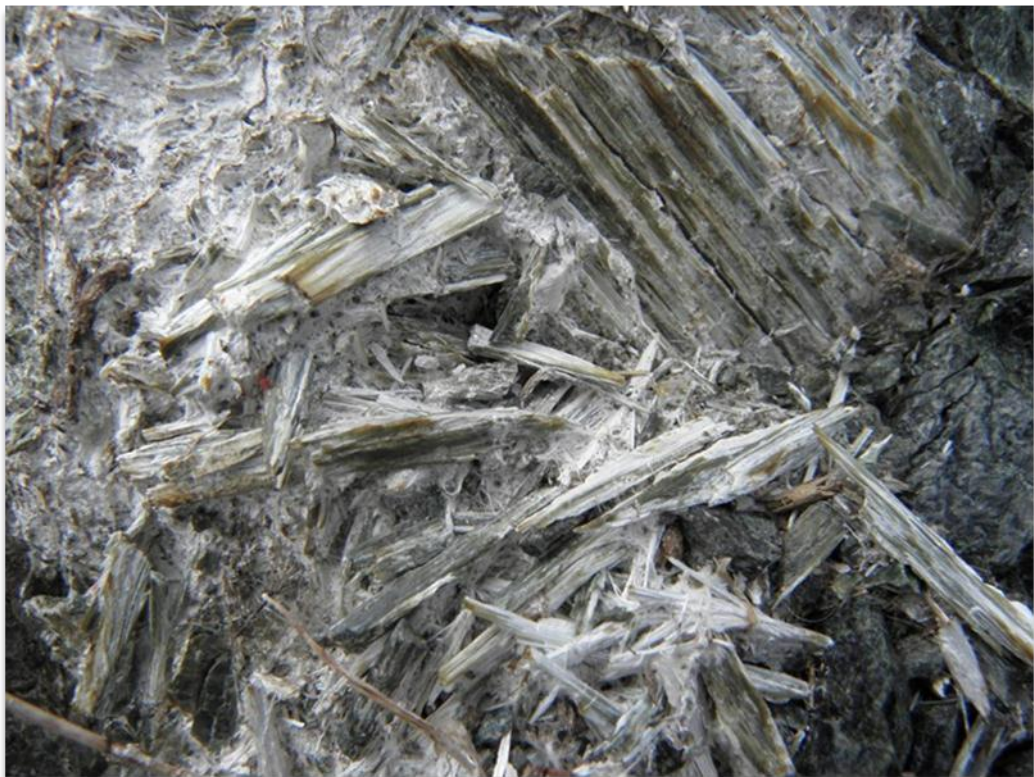
Illustration 26 : Amas de fibres amiantifères dans les serpentinites, sous la bergerie du site 2BFC071.
