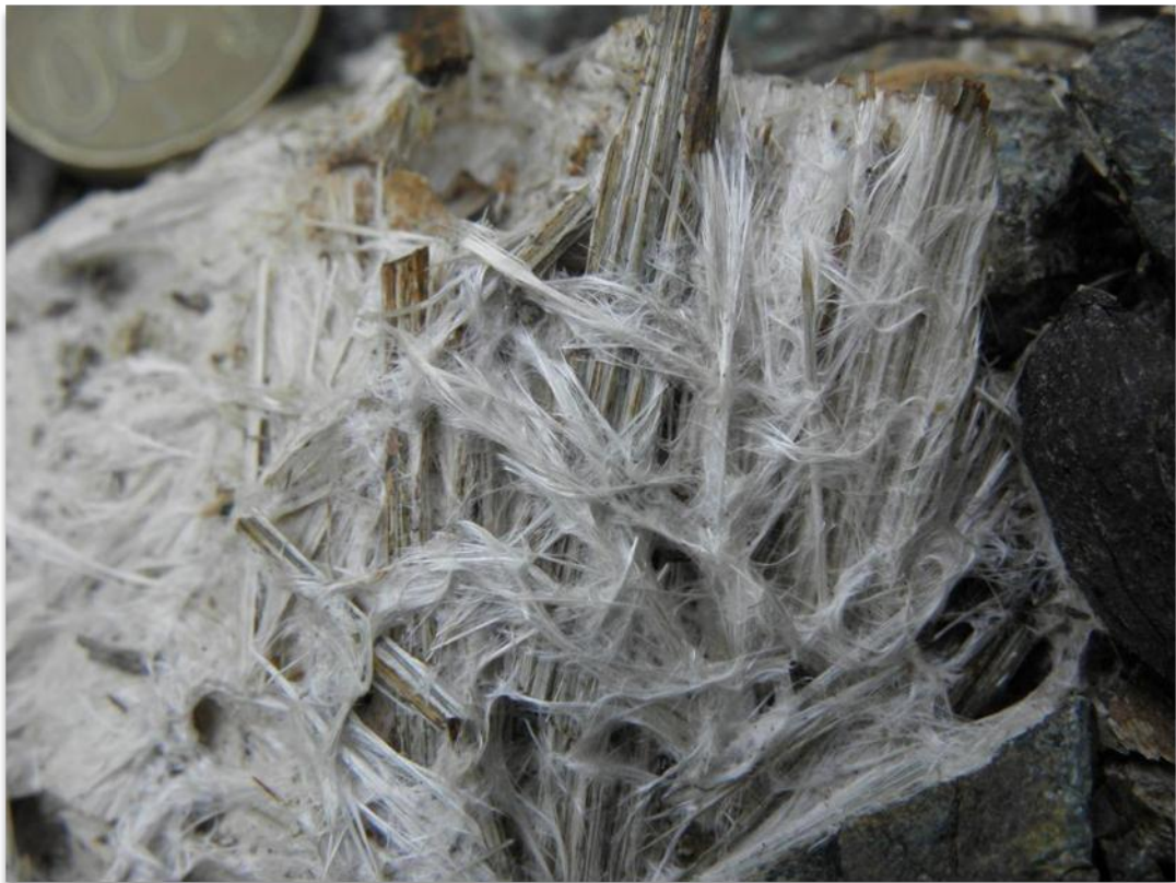
Illustration 12 : Fibres « rigides » et fibres souples (site 2BDL279).
