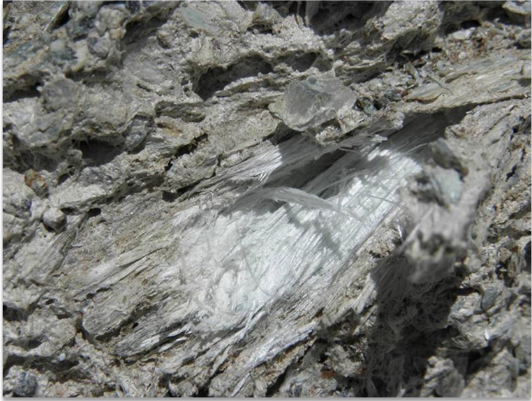
Illustration 15 : Détail d'un amas de fibres fines, flexueuses et volatiles de trémolite (2BFC056).
