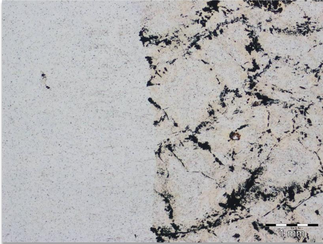
Illustration 48 : Serpentine à texture maillée et veine de serpentine fibreuse, en lumière polarisée non analysée (lame 2BDL287).
