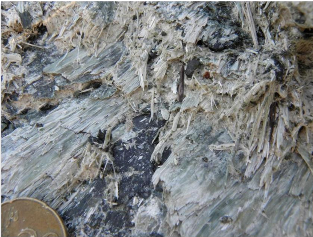
Illustration 100 : Fibres de trémolite échantillonnées au niveau du site 2BDL250.
