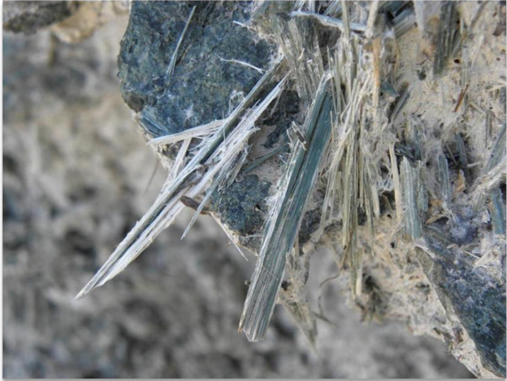
Illustration 101 : Fibres de trémolite échantillonnées au niveau du site 2BDL274.
