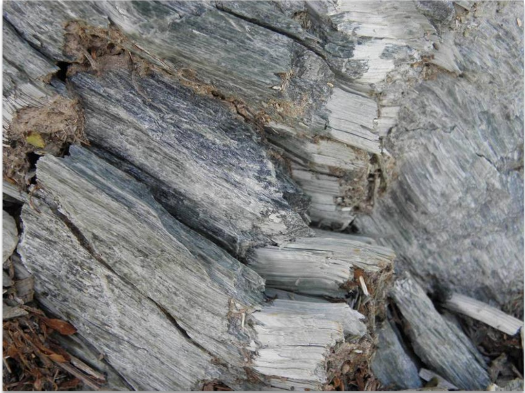
Illustration 23 : Veine se délitant en fibres observée dans des serpentinites altérées (2BFC023).
