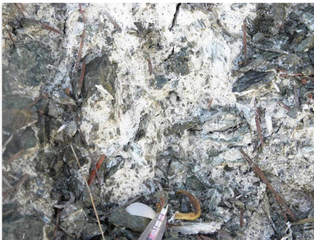
Illustration 32 : Amas de fibres amiantifères au sein des serpentinites (site 2BFC035).
