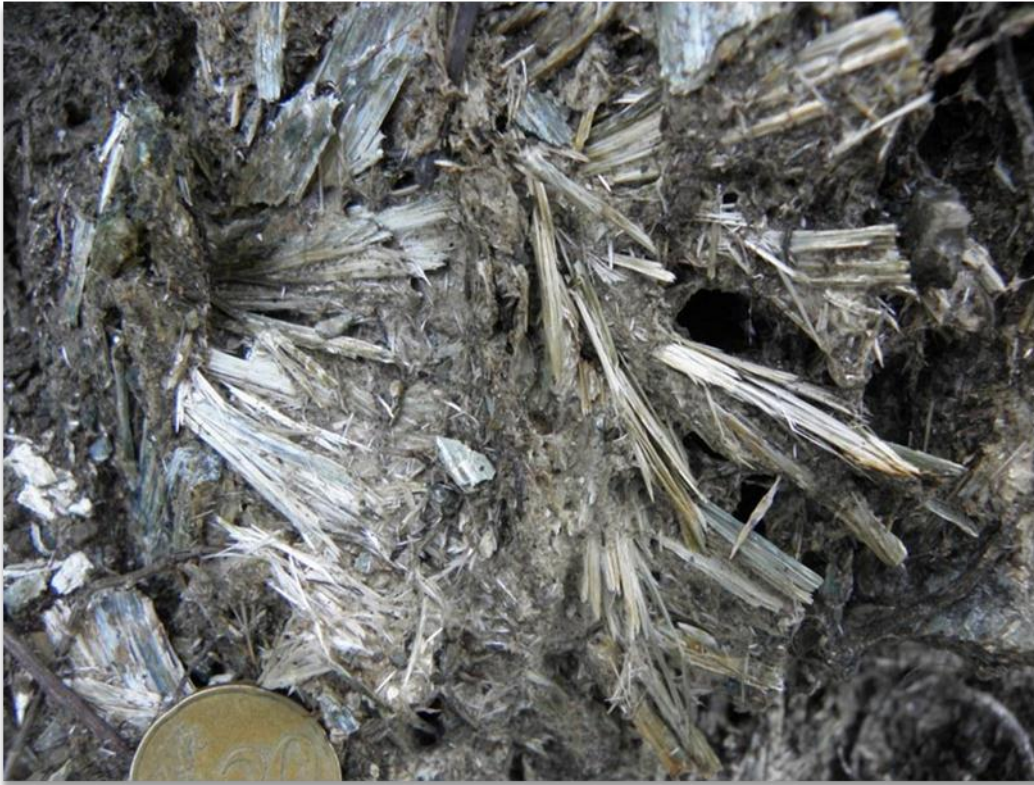
Illustration 99 : Fibres de trémolite échantillonnées au niveau du site 2BDL247.
