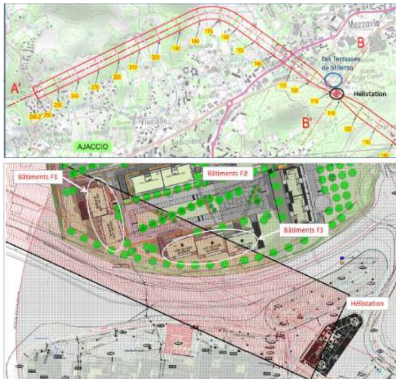
Illustration 4: Positionnement des couloirs autorisés d'approche et de départ de l'hélistation par rapport au projet (Source : étude d'impact)
