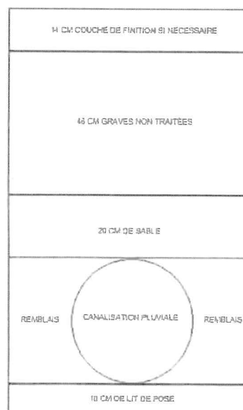
Profil type d'une canalisation pluviale enterrée
