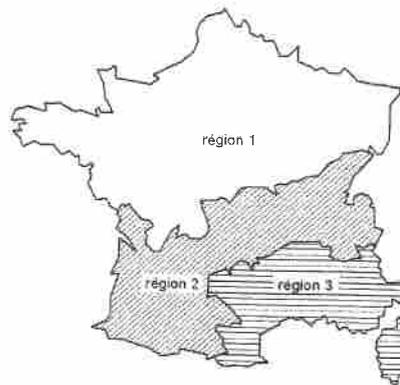
figure 18: Decoupage de la France en régions de pluviométrie supposée homogène, tel que proposé par l'Instruction technique de 1977. Les valeurs reposant sur ce découpage ne doivent plus être utilisées, car la variabilité réelle de la pluviométrie est beaucoup plus importante et des données plus fines sont maintenant disponibles (voir chapitre 7).
