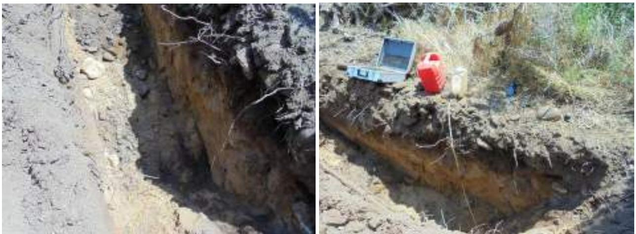
Fig. 7 – Photographies fosse 1 – essai de perméabilité
