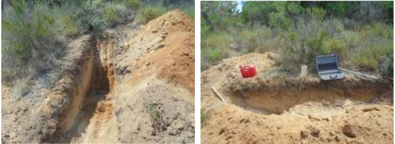
Fig. 8 – Photographies fosse 2 – essai de perméabilité
