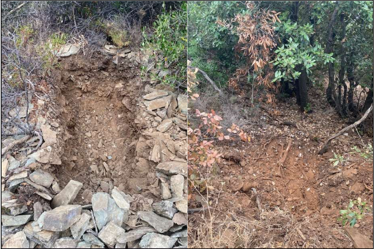
Fig. 5 – Tranchées à la pelle mécanique effectuées à proximité des tests K1 et K2 au niveau de la parcelle A-911
