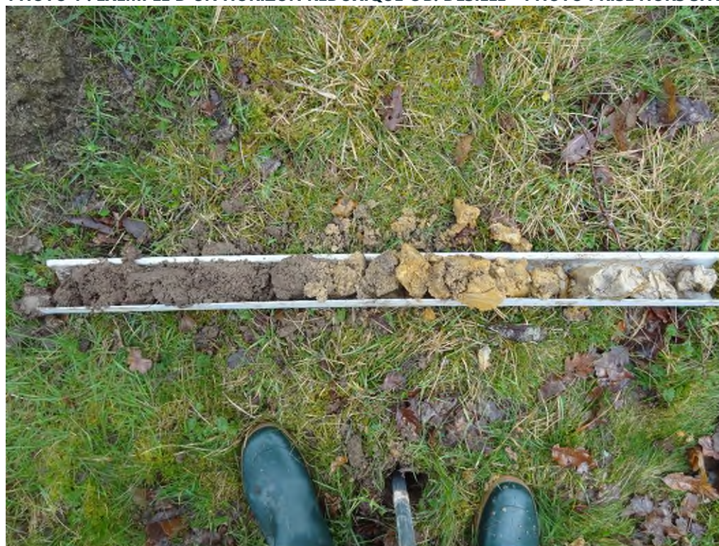
PHOTO 2 : SONDAGE AVEC 3 HORIZONS VISIBLES ET DISTINCTS (NON HUMIDE EN NOIR, RÉDOXIQUE ET ORANGE ET RÉDUCTIQUE EN GRIS) ©B. DESILLE – PHOTO PRISE HORS SITE
