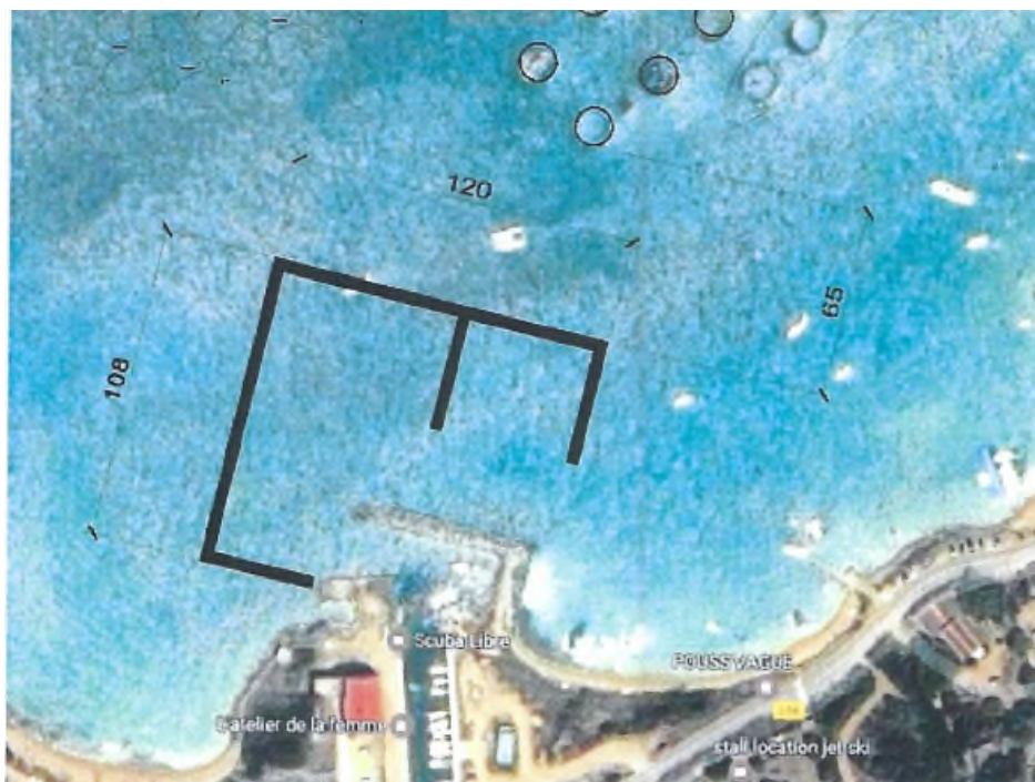
Implantation des pontons flottants
