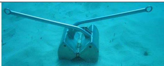
Figure 21 : Benne Van Veen en position ouverte sur fonds sableux
