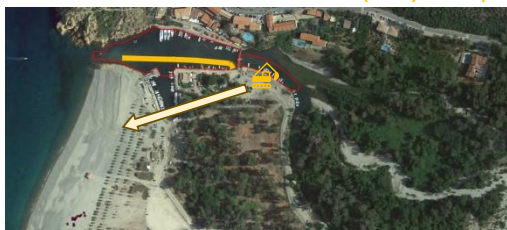
1c : DEBUT DE RECHARGEMENT DE LA PLAGE (2 000m 3 estimés)
