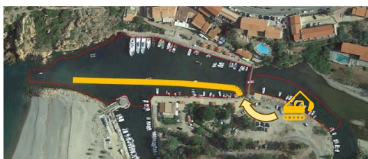
1b : UTILISATION DES SEDIMENTS POUR LA PISTE A L'AVANCEMENT DE LA ZONE AVAL (2 500m 3 estimés)
