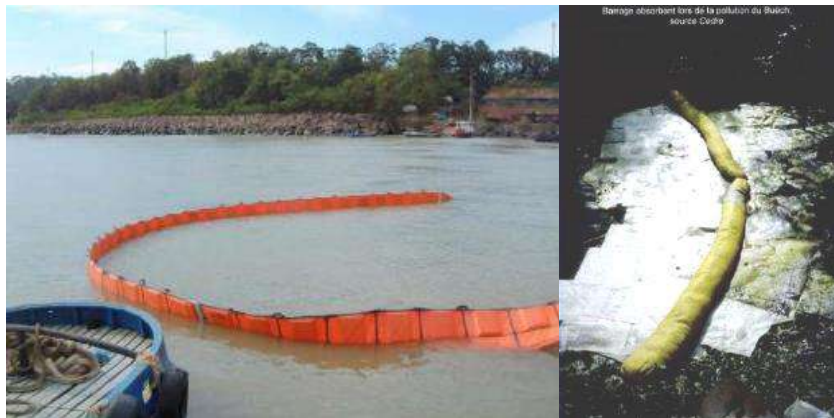
Figure 7 : Installation d'un barrage flottant ( http://www.flexitankchina.fr ) / Barrage absorbant (cedre.fr)
