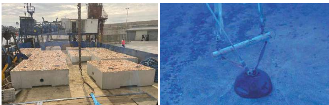
Figure 14 : Photographies de corps-morts béton à gauche et d'un lest en fonte à droite, actuellement expérimenté dans le parc naturel du Cap Corse
