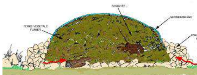
Figure 32 : Schéma de principe d'un site de ponte artificiel pour reptiles (CEREMA DTer SO)
