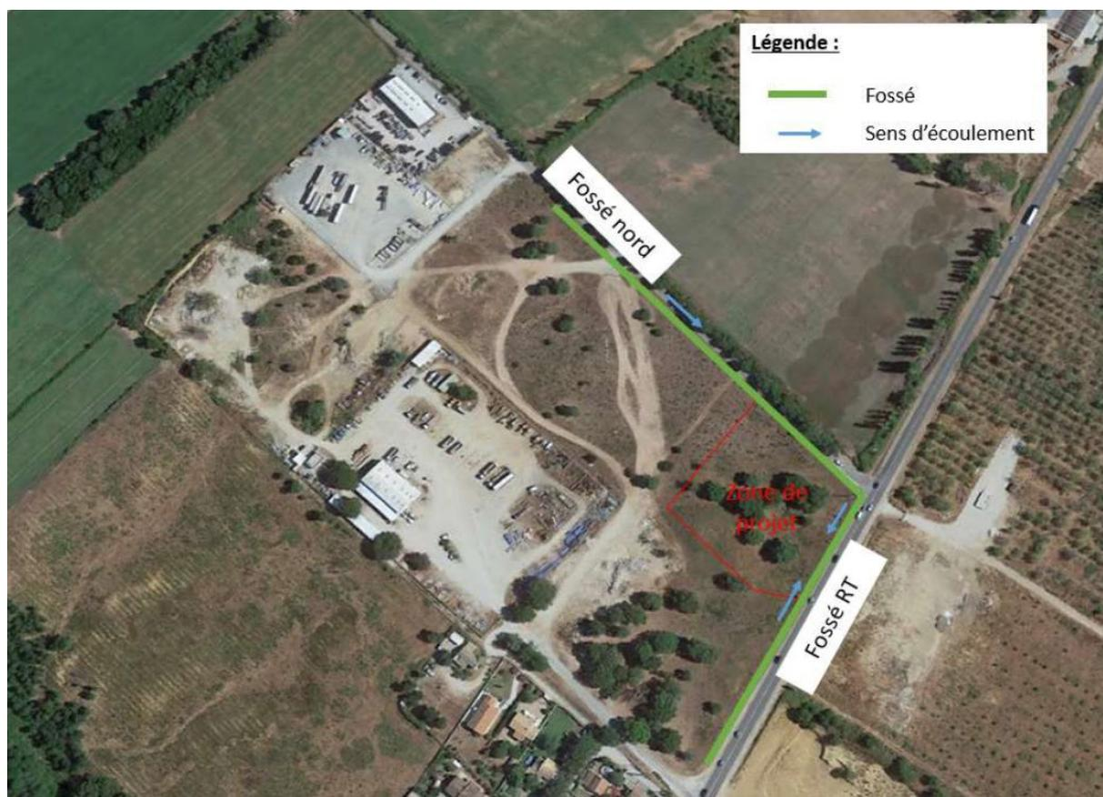
**Figure 13. Ouvrages hydrauliques à proximité de la zone d'implantation du projet**
