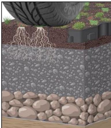
Figure 8 : Support alvéolaire avec substrat perméable végétalisé
