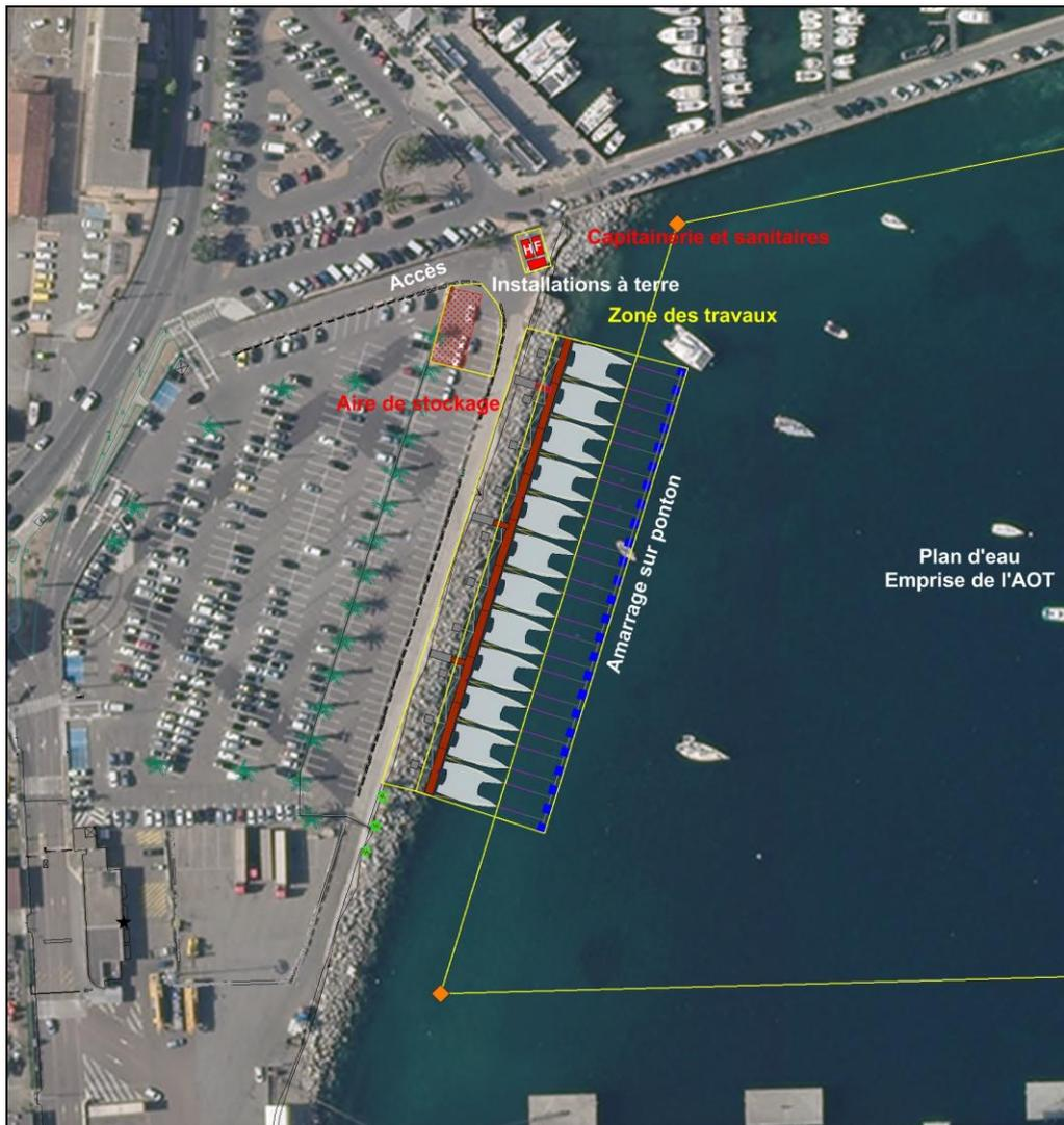
Figure 10 : Plan des aménagements à terre et du ponton d'amarrage
