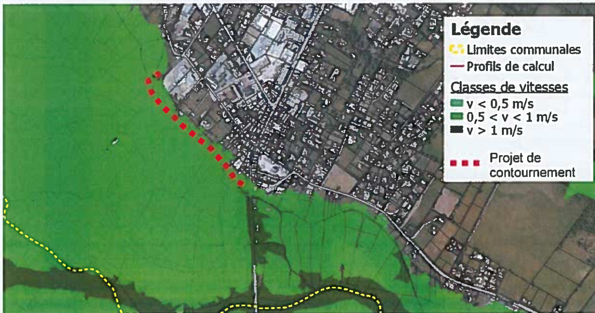
Figure 10: Carte des vitesses du PPRI en cours de révision au droit du projet de contournement
