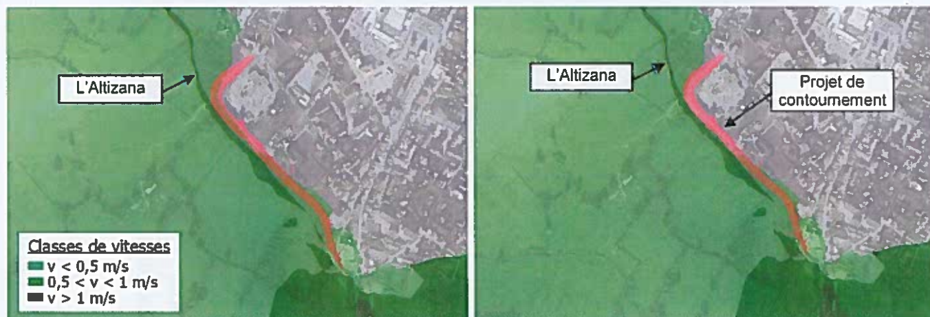
Figure 26: Vitesses d'écoulements au droit du projet à l'état initial (à gauche) et à l'état aménagé (à droite)
