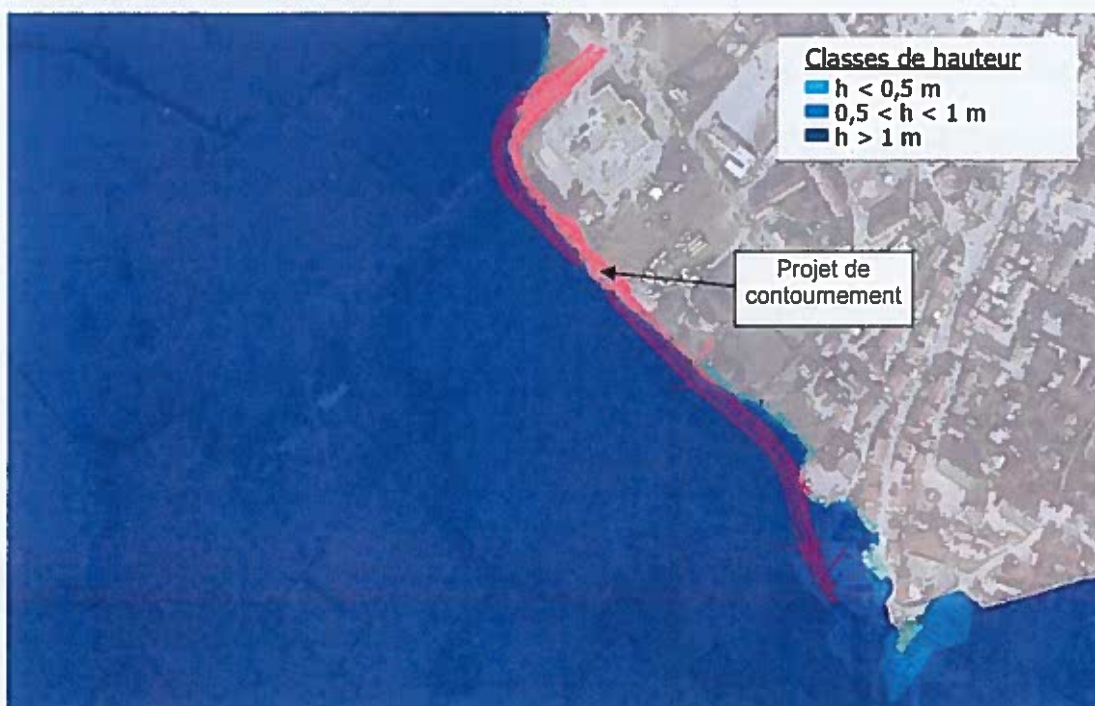
Figure 20: Hauteurs d'eau à l'état initial au droit du futur contournement de Ghisonaccia
