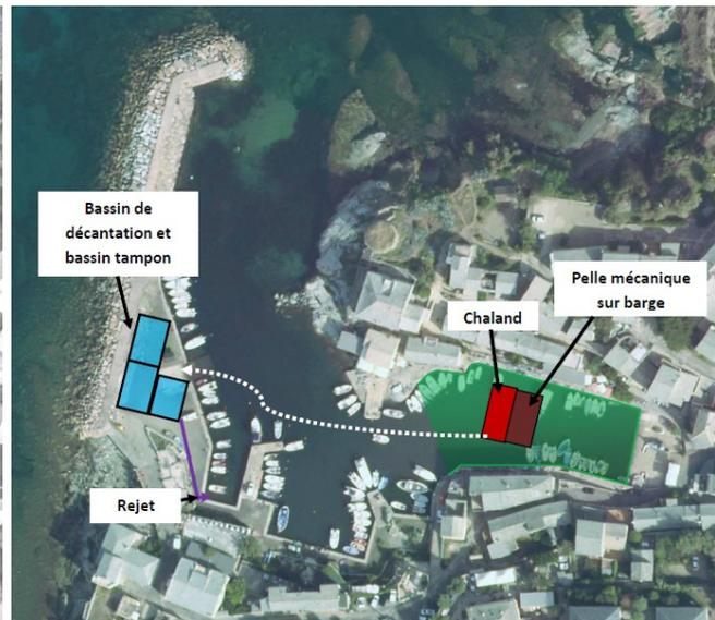
Figure 3 : plan de localisation du chantier de dragage et « traitement » des matériaux
