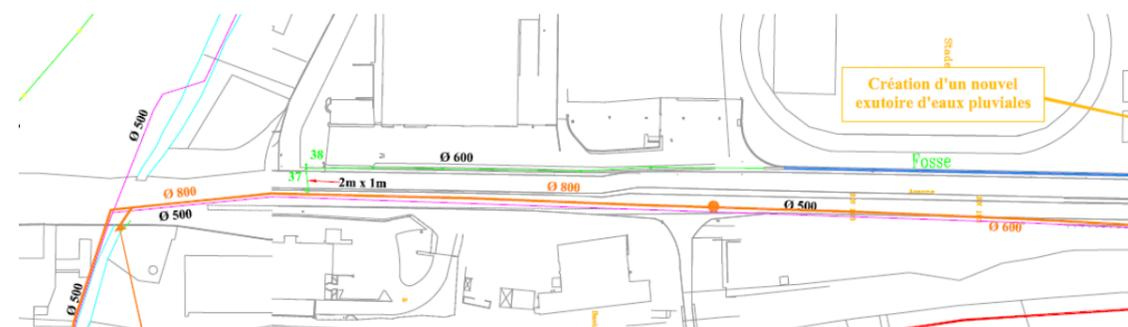
FIGURE 17 : FONCTIONNEMENT HYDRAULIQUE ACTUEL DE LA PARTIE SUD DE L'AMENAGEMENT, EXTRAIT DU SCHEMA DIRECTEUR DE LA VILLE DE BASTIA
