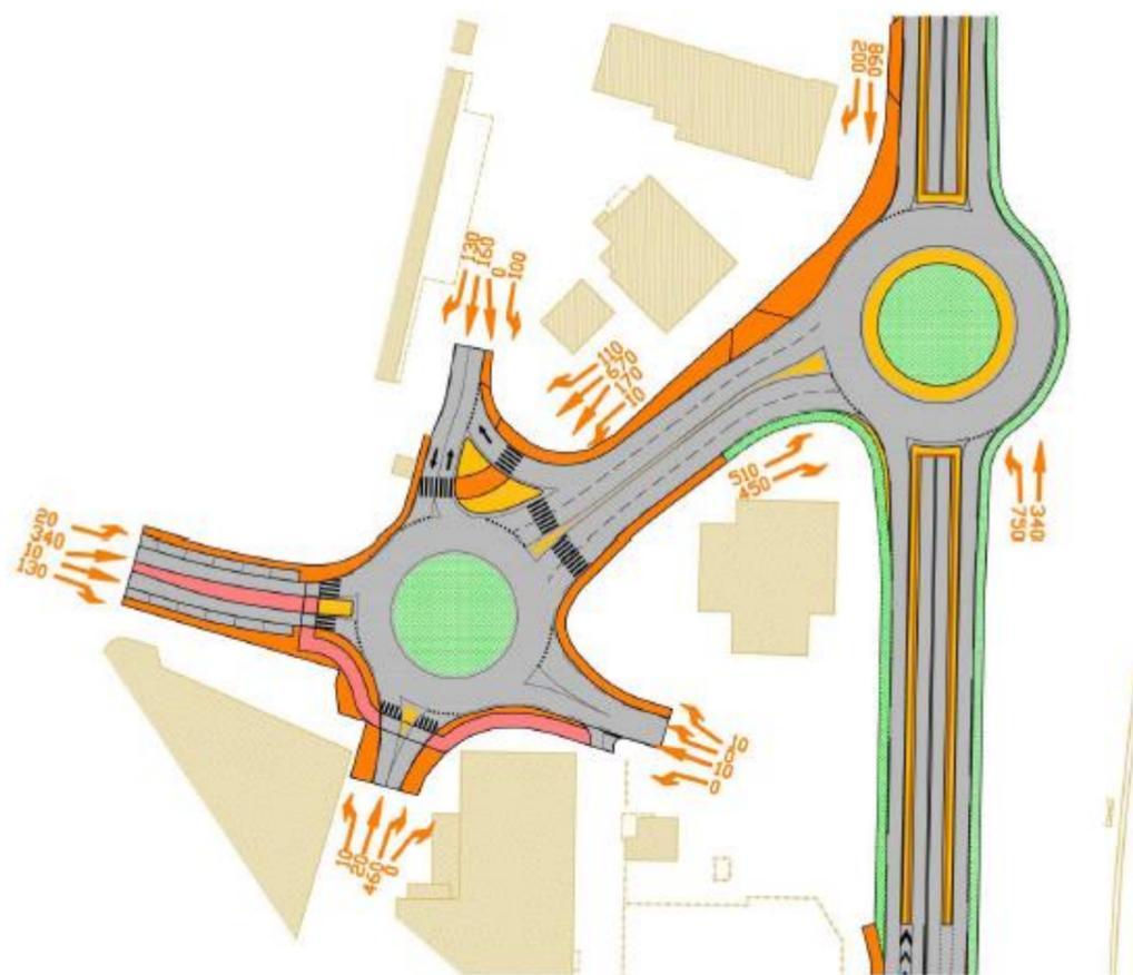
FIGURE 5 : PROJECTION DU TRAFIC LORS DE LA MISE EN PLACE DU CARREFOUR GIRATOIRE A MOYEN TERME (2023)
