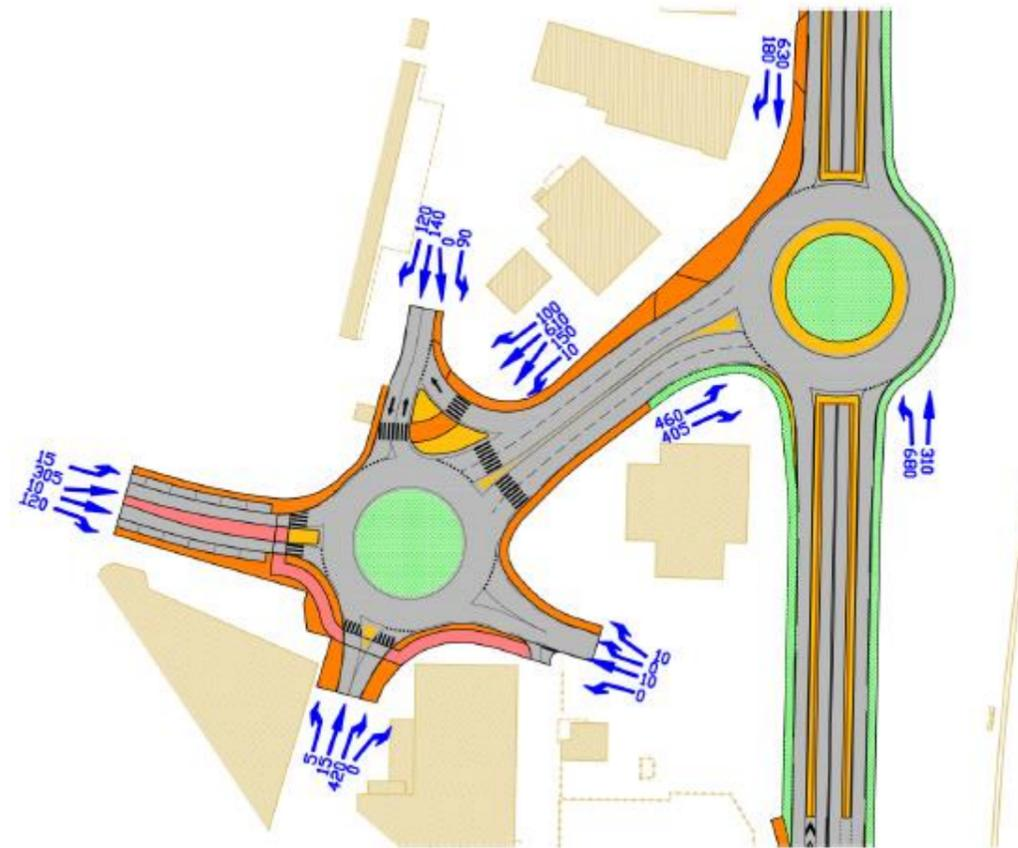
FIGURE 2 : PROJECTION DU TRAFIC LORS DE LA MISE EN PLACE DU CARREFOUR GIRATOIRE
