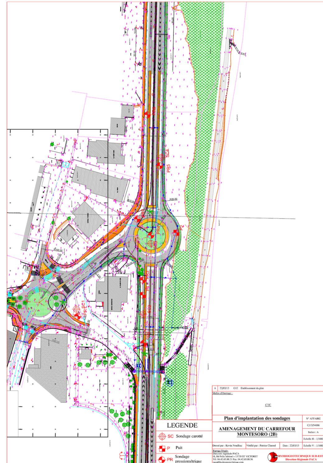
FIGURE 7 : LOCALISATION DES INVESTIGATIONS GEOTECHNIQUES DE MARS 2013 (SOURCE : HYDROGEOTECHNIQUE)
