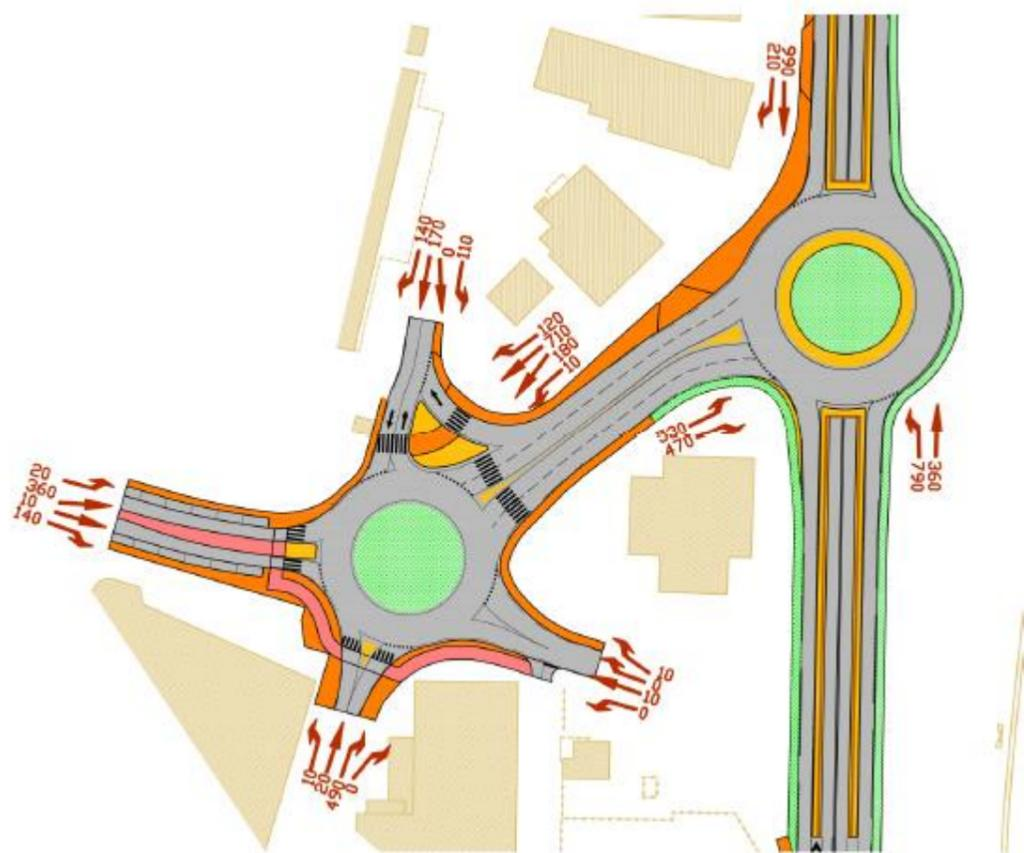
FIGURE 7 : PROJECTION DU TRAFIC LORS DE LA MISE EN PLACE DU CARREFOUR GIRATOIRE A LONG TERME (2033)
