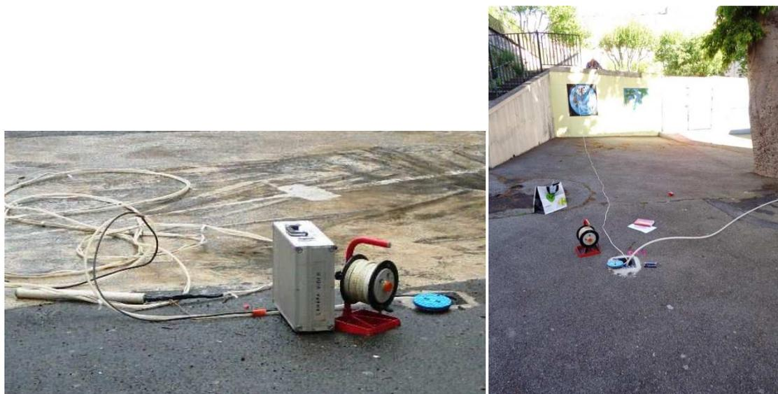
**Figure 6** – Matériel de pompage et de mesure de niveau
