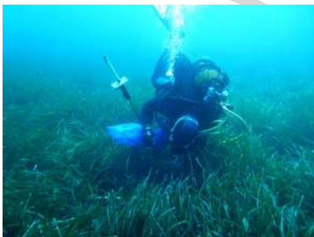
▲ Photo 32 - Mesure de la compacité de la matre par un biologiste de Stareso à l'aide d'un compaciteur de masse
