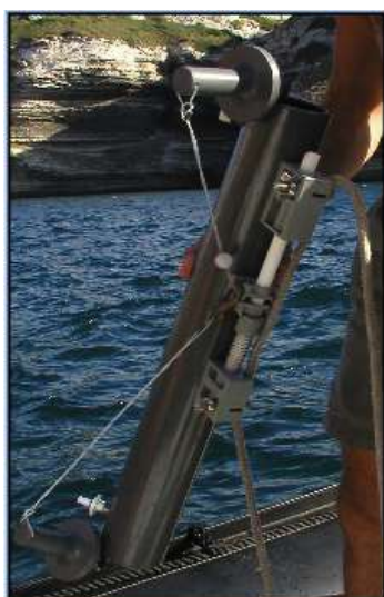
▲ Photo 31 – Prélèvement dans la colonne d'eau à l'aide d'une bouteille Niskin
